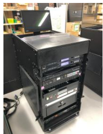
A/B/C同仕様の 音響・映像操作ワゴン
